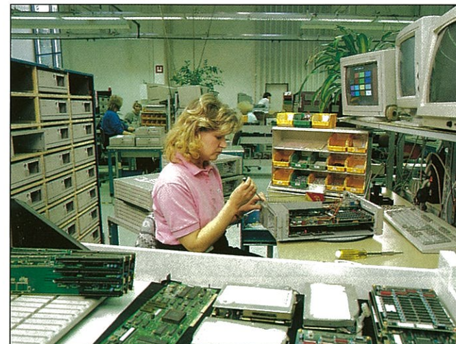
Arja Pyhälä kokoaa MikroMikko 3TT:n pikku palikoista valmiiksi tuotteeksi.
