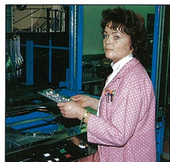
Ruskon modeemitehtaalla pyritään automatisoimaan rutiinitöitä. Suurin osa komponenteista pystytään jo latomaan koneellisesti. Uusi radiaalikomponenttien ladontakone on juuri hankittu tehtaalle. "Nopiaan tulle", kertoo Kyllikki Eronen.
